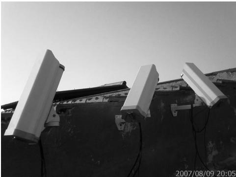
Γίνεται παρουσίαση του πρώτου Ελληνικού Σταθμού Παρατήρησης Μετεώρων. Το σύστημα αποτελείται από 3 ταυτοτικά ίδιες CCD κάμερες, οι οποίες καλύπτουν περίπου το 65% του ορατού ημισφαιρίου. Τα δεδομένα του σταθμού καταγράφονται και αναλύονται αυτόματα από λογισμικό για την ανίχνευση μετεώρων και βολίδων. Επίσης μπορούν να χρησιμοποιηθούν για την μέτρηση της ταχύτητας, τον υπολογισμό της τροχιάς, του ακτινοβόλου σημείου
